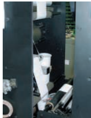
Schneidstation der Maschine, wo der Randbeschitt anfällt
